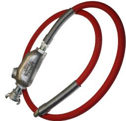
Acople Media Vuelta UH 3/4" Vástago, UH075, para sistemas neumáticos, mangueras y herramientas de función con aire comprimido, acoplamiento de paso libre, cierre a 1/4 de vuelta a través de encastres inversos ubicados en el cuerpo del acople, sellamiento por junta de goma alojada en el interior del cuerpo.
