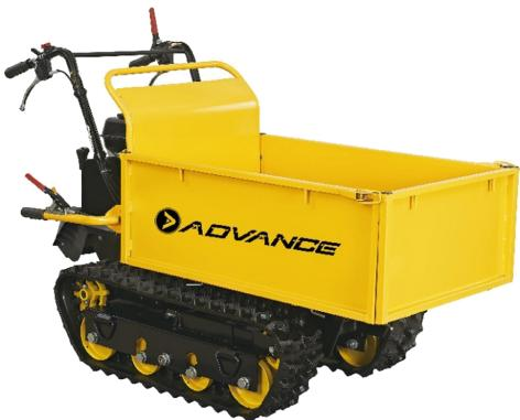
Carretilla Transportadora sobre Orugas Advance 600Kg 6.5Hp Volcó Manual TAG600, ideal en el transporte de equipos y residuos propios del campo y la jardinería, con capacidad de hasta 600kg de peso, es autopropulsada por un motor de 6.5Hp y basculante tipo manual , de ágil desplazamientos incluso en terrenos difíciles como terrenos con tierra suelta, pendientes inclinadas e incluso escalones pronunciados.
