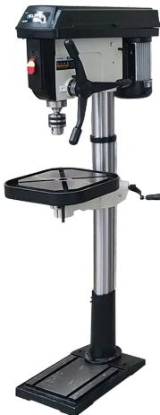
Taladro de Árbol Elite 1.100 W, TA1100, de uso industrial con motor en cobre de alto rendimiento con una Potencia de 1.5 Hp y Switch de seguridad. Cuenta con 12 velocidades ,manijas forjadas y columna de acero para trabajo pesado.
