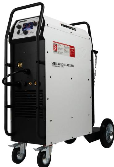
Soldador Inversor Multipropósito SWEISS 400 AMP – 220-440V, StellaWorks 4070MV, Recomendado para electrodos: 6010, 6011, 6013, 7018, Inox, fundición, y otros, Diámetro alambre: 0.024" (0.6mm) – 1/16" (1.6mm), Diámetro de electrodo: 1/16" (1.6mm) – 1/4".
