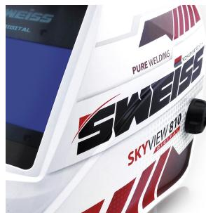
Careta para soldadura Swiss SkyView 810 Dig Alta Vel con reg 5-8 / 9-13, SOSWC1-811, con regulación 5-8 / 9-13 + Grinding, Alta velocidad de Oscurecimiento de <1/30,000 S. , regulación de DIN (4/9-13), Regulación de Sensibilidad y retardo. Area de Visión de 100x60 mm. Certificaciones; EN379:2009;CE,ECS (NB.1883) CE 1/1/1/2 BATERIA INTERCAMBIABLE
