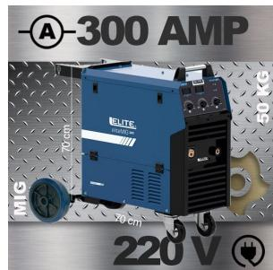
Soldador Inversor Elite 300 AMP -220V, MIG 300, SOELKSI8300MG, permite soldar alambre de hasta 0,045? al 60% y 0,035 al 100%. No permite innershield o autoprotegido BOBINA / CARRETE 5 y 15 KG.
