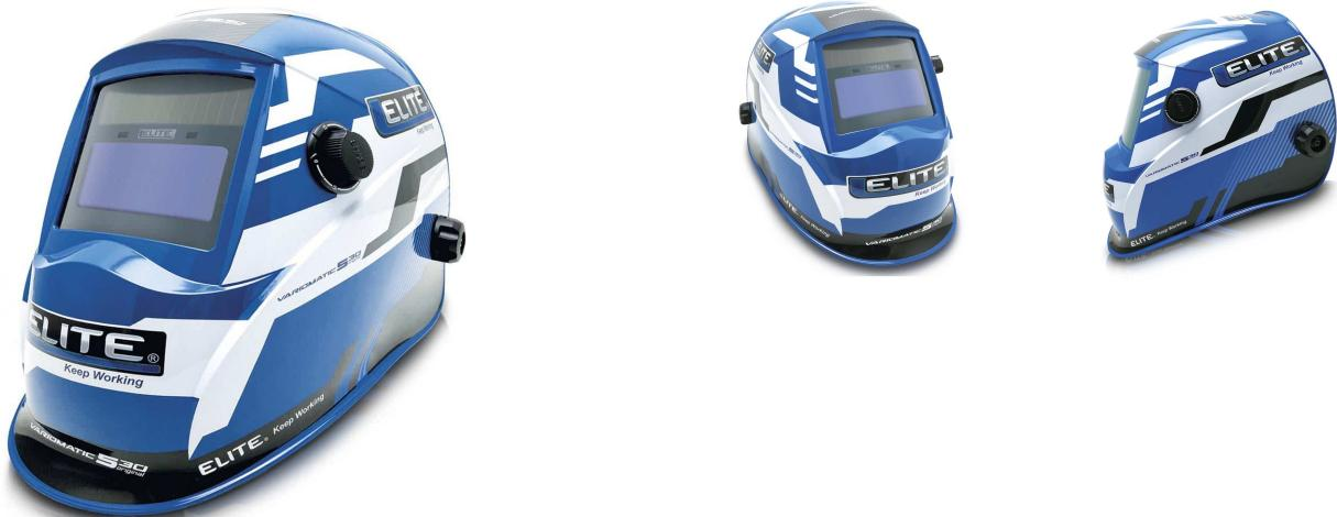
Careta para soldadura Elite Variomatic 530 Alta Vel con reg 9-13, SOELCSVM530, Alta velocidad de Oscurecimiento de <1/30,000 S., regulación de DIN (4/9-13), Regulación de Sensibilidad y retardo. Área de Visión de 96x40 mm. Certificaciones; EN379:2009;CE,ECS (NB.1883) CE 1/1/1/2
