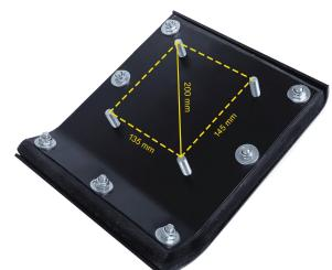
Zapata Apisonador 33 x 28 mm, diseño de alta resistencia transfiere la fuerza del equipo de forma homogénea sobre el material a compactar, base en placa de acero templado, capas de amortiguación en madera laminada, capa superior en acero, tornillos de sujeción de 10 mm diseño reforzado para resistir los impactos transferidos propios de su labor.
