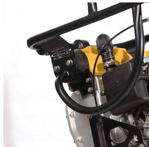
Amortiguador Lateral Apisonador. Componente encargado de absorber los contragolpes (golpe de retroceso que ejerce la maquina al accionarse) favoreciendo tanto la integridad de la maquina como la salud del operador ya que disminuye la transmisión de estos golpes al usuario.
