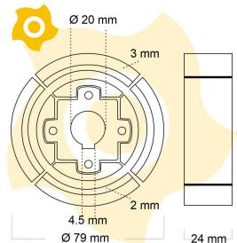
Embrague Apisonador Diésel SG70R008-2, Clutch Centrifugo Ø diámetro 79 mm cerrado, embrague CPL Apisonador Motor Diésel MS840 Chicago Pneumatic Hatz, su diseño usa la fuerza centrífuga para transmitir la potencia del motor al equipo, extendiendo sus masas al sobrepasar una velocidad, superficie de fricción en material cerámico 3 mm, bloques de expansión reforzados y centro de eje de 20 mm.
