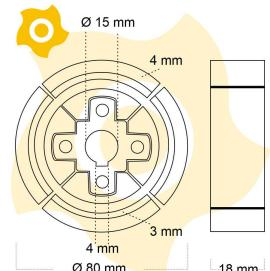
Embrague Apisonador Gasolina Eje 15mm Embrague Apisonador Gasolina, Clutch Centrifugo Ø diámetro 80 mm cerrado, su diseño usa la fuerza centrífuga para transmitir la potencia del motor al equipo, extendiendo sus masas al sobrepasar una velocidad, superficie de fricción en material cerámico 4 mm, bloques de expansión reforzados y centro de eje de 15 mm.
