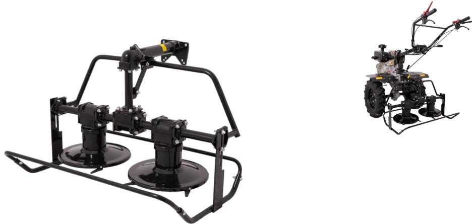
Segadora para Motoazada MADECO12 Ecomax, SEGADORA-E, es un accesorio de doble disco diseñado para corte de hierbas y pastos altos, así como para trabajos con trigo y otros cereales similares; se fija a la motoazada Ecomax MADECO12. Viene con manual en español, y está pensado para quienes necesitan un corte efectivo de vegetación densa y de porte alto, optimizando tiempos y esfuerzo en labores agrícolas.
