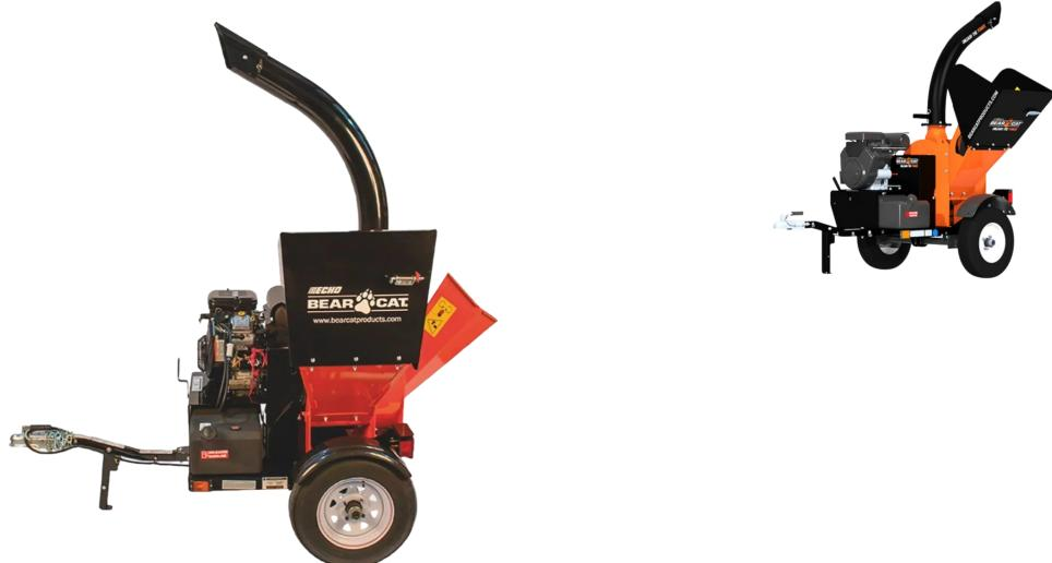
Chipeadora Gasolina Bear Cat 7? 23hp 670cc SC5627B, chipeadora/trituradora combinada de alta capacidad, diseñada para procesar ramas de hasta 5? (127?mm) de diámetro. Equipada con motor Briggs & Stratton gasolina de 23?HP, cuenta con 4 cuchillas, 36 martillos, sistema de alimentación por gravedad y arranque eléctrico. Su diseño con remolque y tanque de 9 galones la hace ideal para aplicaciones residenciales avanzadas, agrícolas y paisajismo profesional.
