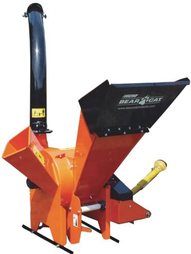
Chipeadora Acople a Tractor PTO Bear Cat 5" 25 – 35hp SC5540B, chipeadora/trituradora diseñada para trabajar con tractores de 25 a 45?HP mediante toma de fuerza (PTO). Procesa ramas de hasta 5? (127?mm) en el sistema de chipeo y materiales de hasta ¾? (19?mm) en el sistema de trituración, con 4 cuchillas y 36 martillos para una reducción eficiente del material. Su sistema de alimentación por gravedad y operación a 540?rpm la hace ideal para aplicaciones agrícolas y de mantenimiento de terrenos.
