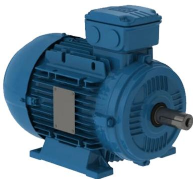
Motor Eléctrico WEG 50hp 3F 3600rpm IP55 PG050363AQA, aislamiento clase "F" (elevación de temperatura clase "B" – 80K), temperatura ambiente 40°C a 1000msnm, tensión, 220/440 V (hasta carcasa 90S/L), 220/380/440 V (a partir de carcasa 100L), Factor de servicio: 1,15, categoría: N, régimen continuo: S1, placa de bornes (6 terminales), termistores (1 por fase) para desconexión (desde carcasa 160 hasta 200).
