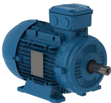
Motor Eléctrico WEG 40hp 3F 1800rpm IP55 PG040183AQA, aislamiento clase "F" (elevación de temperatura clase "B" – 80K), temperatura ambiente 40°C a 1000msnm, tensión, 220/440 V (hasta carcasa 90S/L), 220/380/440 V (a partir de carcasa 100L), Factor de servicio: 1,15, categoría: N, régimen continuo: S1, placa de bornes (6 terminales), termistores (1 por fase) para desconexión (desde carcasa 160 hasta 200).
