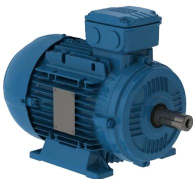
Motor Eléctrico WEG 2.0hp 3F 1200rpm IP55 PG002123AQA, aislamiento clase "F" (elevación de temperatura clase "B" – 80K), temperatura ambiente 40°C a 1000msnm, tensión, 220/440 V (hasta carcasa 90S/L), 220/380/440 V (a partir de carcasa 100L), Factor de servicio: 1,15, categoría: N, régimen continuo: S1, placa de bornes (6 terminales), termistores (1 por fase) para desconexión (desde carcasa 160 hasta 200).
