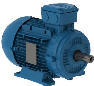
Motor Eléctrico WEG 0.5hp 3F 1200rpm IP55 PG.50123AQA, aislamiento clase "F" (elevación de temperatura clase "B" – 80K), temperatura ambiente 40°C a 1000msnm, tensión, 220/440 V (hasta carcasa 90S/L), 220/380/440 V (a partir de carcasa 100L), Factor de servicio: 1,15, categoría: N, régimen continuo: S1, placa de bornes (6 terminales), termistores (1 por fase) para desconexión (desde carcasa 160 hasta 200).
