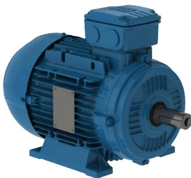
Motor Eléctrico WEG 0.25hp 3F 1800rpm IP55 PG.25183AQA, aislamiento clase "F" (elevación de temperatura clase "B" – 80K), temperatura ambiente 40°C a 1000msnm, tensión, 220/440 V (hasta carcasa 90S/L), 220/380/440 V (a partir de carcasa 100L), Factor de servicio: 1,15, categoría: N, régimen continuo: S1, placa de bornes (6 terminales), termistores (1 por fase) para desconexión (desde carcasa 160 hasta 200).
