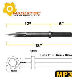
Cincel Punta Aguda encastre HEX 1-1/4" x 6" x 18" Autoafilable, MP3 para martillos neumáticos, gracias a su poderosa punta aguda es indicado en aplicaciones de demolición, así como trabajos de detallado y precisión, indicado para martillos de 60 a 90 Lb.
