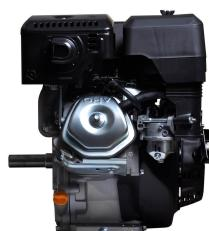
Motor gasolina Eco 9Hp, MG9, Diseño de válvula aérea (OHV), baja temperatura de funcionamiento, ahorro de aceite, carcasa en hierro fundido que mejora eficazmente la lubricación y hace al motor más resistente al desgaste prolongando su vida útil, Alarma automática y parada por bajo nivel de aceite, La leva de metal y el cigüeñal forjado hacen que el motor sea más confiable y duradero.
