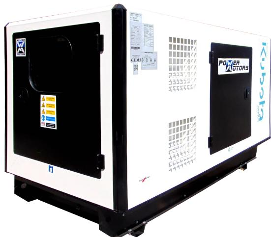
Planta Eléctrica Diésel Power Motors 39.7KVA Trifásico 110/220V 31gal T. Digital, KT36-C, generador diésel trifásico con tablero digital con tecnología AVR, sistema de arranque eléctrico y refrigeración de agua, rendimiento continuo en todo tipo de uso, ya sea en usos eventuales o de emergencia.
