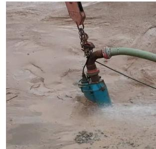
Electrobomba Tsurumi con Agitador 3" Des 5.5Hp 220/440V 3F KRS2-80, drenaje general, de bajo peso para desagüe de aguas con arenas, provenientes de aplicaciones de construcción, industriales y minería.
