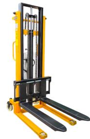
Estibador de Altura Hidráulico 2.0Ton 3.0mt Red Lift KC-2B30, de estructura reforzada y horquillas reforzadas en su extensión, rueda de Nylon de alta resistencia y durabilidad, con Doble cadena de elevación, malla de protección y freno auxiliar, capacidad de hasta 2.0 toneladas, este montacargas apilador manual es ideal en el manejo de cargas para remontar y organizar en alturas como en racks y estanterías industriales, así como carga de estibas en vehículos. Altura máxima de elevación 3000mm
