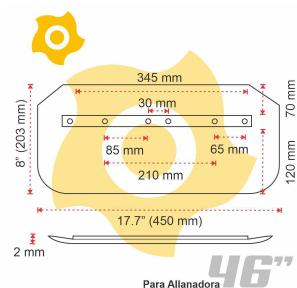
Aspas en Acero para Allanadora 46" x4Und, en acero inoxidable permiten una operación combinada tanto en el allanado del concreto como en el acabado de la superficie, ideales para trabajos de gran extensión, su composición y diseño facilitan acabados mas detallados.(helicóptero, fratasadora, allanado).
