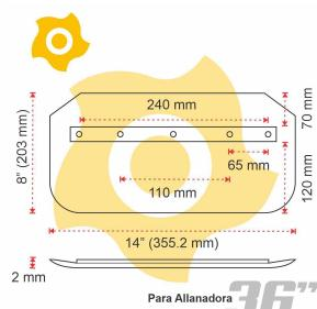
Aspas en Acero para Allanadora 36" x 4 Und, en acero inoxidable, permiten una operación combinada tanto en el allanado del concreto como en el acabado de la superficie, ideales para trabajos de gran extensión, su composición y diseño facilitan acabados más detallados. (helicóptero, fratasadora, allanado).
