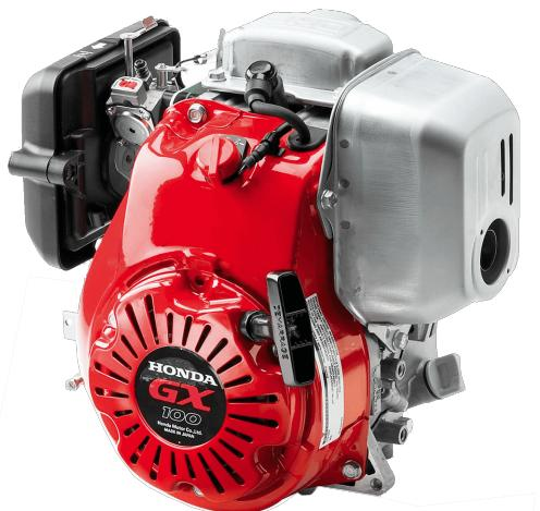
Motor gasolina Honda GX100RT 3,0 hp, Soporta altas vibraciones, especial para apisonador, ideal en multiples aplicaciones ya sea industria o construcción, correa de distribución silenciosa, camisa de cilindro de acero al carbón y cojinetes de bolas en el cigüeñal, que aseguran una gran durabilidad y rendimiento, el arranque y la tapa del ventilador están hechos de acero para incrementar la dureza del motor.
