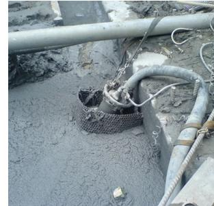
Electrobomba Tsurumi con Agitador 6" Des 30Hp 220/440V 3F GPN622, drenaje general, de bajo peso para desagüe de aguas con arenas, provenientes de aplicaciones de construcción, industriales y minería.
