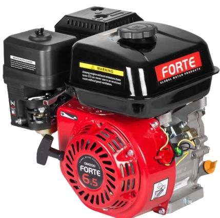
Motor Gasolina Forte 6.5Hp, 3600 rpm, eje roscado, GM200FW, peso seco de 18 kg, eje roscado y la capacidad de tanque de combustible de 3,6 L.
