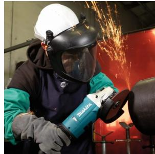
Pulidora Makita 9 Pulgadas 2200W GA9020 , esta pulidora angular para uso profesional exigente te ofrece una potencia de 2.200 W con capacidad para un disco de 230 mm para aplicaciones exigentes que requieren gran capacidad. Te ofrece una mpuñadura lateral y cambio de rueda sin herramientas, además de durabilidad excepcional, una mayor resistencia al calor, estructura superior anti-polvo, y un engranaje cónico fabricado para obtener una mayor fuerza.
