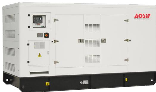
Planta Eléctrica Diésel Cabinada Leroy Somer 550kVA 127/220V 3F FC500X-LP, motor Lister PetterCummins con capacidad de arranque de alto desempeño para cargas pesadas, gobernador electrónico para una variación mínima de voltaje y frecuencia, mantenimiento sencillo, múltiples entradas de aire que facilitan su posicionamiento en casi cualquier lugar, cabina insonora con diseño eficiente que ayuda a reducir temperatura, generador Leroy Somer, serie TAL de ultima tecnología.
