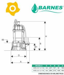
Electrobomba Barnes Aguas residuales, E0926, Para Achique, 3.600 rpm, 2? Des 0.5 Hp, Estructura e Impulsor en Hierro fundido ASTMA-48, motor Eléctrico, ideal en Bombeo de agua con sólidos en suspensión, Control de niveles freáticos, Desagüe de zonas inundadas, Fuentes decorativas, Manejo de agua en beneficiaderos de café, Manejo de aguas, residuales o negras, Plantas de tratamiento, Pozos sépticos, Riego de estiércol.
