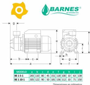
Electrobomba Barnes Periférica 1x1 1 Hp, E0326, de estructura en Hierro y Motor eléctrico sus aplicaciones van desde: Aprovisionamiento de aguas limpias, Recirculación de agua en torres de enfriamiento, Refrigeración de maquinaria/Circuitos de recirculación, Sistemas de Presión, Equipos contra incendio, Plantas de tratamiento, Riego por goteo.
