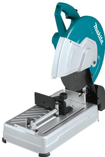
Tronzadora Inalámbrica Makita 14 Pulgadas 36V DLW140Z, Indicador del status de la carga, a medida que aumenta la carga del motor, la lámpara de iluminación aumenta, ajuste sin herramientas de la placa guía, permite un fácil ajuste de la placa guía mediante un manejo sencillo: cambio de posición en 3 etapas, ajuste de ángulo de 0 a 45 grados, asa ergonómica para fácil transporte, Incluye Disco de corte No incluye Baterías ni cargador
