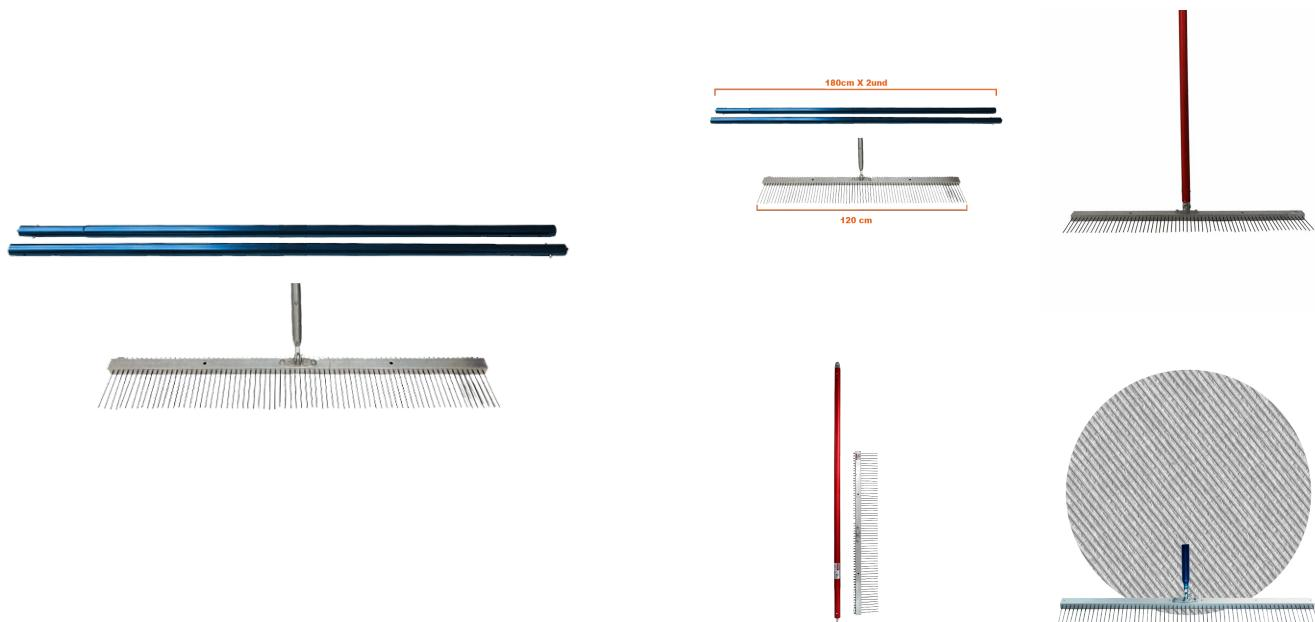
Cepillo Texturizador para Concreto 120 x 360cm CT1-2M, herramienta para acabado de concreto profesional, otorga una textura anti-derrapante sobre la superficie del concreto, 77 cerdas aceradas crean pequeños canales simétricos homogéneos y equidistantes entre si, ideal para acabados de vías, rampas, instalaciones ganaderas, industria y cualquier superficie que requiera esta característica.
