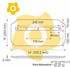
Aspas Blue para Allanadora 36" x4Und, hechas en acero con aleación de alta resistencia a la abrasión, realizan su función combinada permitiendo tanto el allanado del concreto como como el acabado de la superficie, (helicóptero, fratasadora, allanado)
