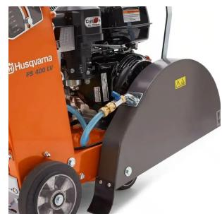
Cortadora de Piso Husqvarna FS400 motor Honda 18", 965148201, robusta, práctica y versátil con motor a gasolina. Su manillar ajustable asegura una postura de trabajo ergonómica. Su perfecta distribución del peso proporciona una excelente estabilidad durante el corte. Ideal para trabajos de reparación en pequeñas carreteras, con una profundidad de corte hasta 162 mm.
