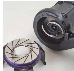
Electrobomba Tsurumi Aguas Negras Cortadora 3" Des 2Hp 220/440V 3F 80C21.5, línea industrial impulsor con cuchilla, plato de succión aserrado usado en combinación con un impulsor con un inserto (cuchilla) de tungsteno, aseguran que se puedan cortar las partículas sólidas presentes en las aguas residuales, bombeando las aguas negras y evitando atascamientos de la tubería.
