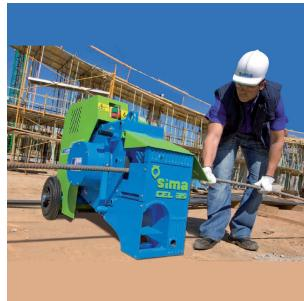
Cizalla Eléctrica Industrial Sima 30mm 230/400V 3F 60Hz CEL36P 8039 cortadora de varilla en versión trifásica de 230/400V, con dispositivo magnetotérmico, para aquellos entornos de trabajo que no cuenten con estabilidad en el suministro. Permiten, igualmente, ahorrar el costoso alquiler de un grupo electrógeno, todos los modelos CEL incorporan los sistemas de seguridad exigidos por las normativas de protección y seguridad internacionales.
