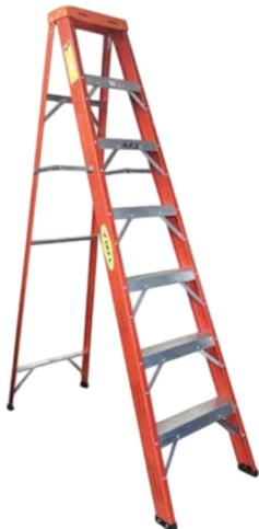
Escalera de Tijera Fibra de Vidrio Red Lift Tipo IA 6E 1.80mt 113kg, 730106CP-TIA, es una escalera tipo IA en fibra de vidrio es autosoportable, no requiere superficie de apoyo. Tiene propiedades diélectricas segura para usar alrededor de campos eléctricos. Resistente a la corrosión. Soporta rigidez diélectrica de 90Kv.
