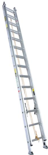
Escalera de Extensión Red Lift Tipo IA 16E 5.00mt 136kg, 710316-TIA, esta compuesta por dos cuerpos que se deslizan uno sobre el otro para lograr mayor altura. Peldaños en D, que garantiza un sistema antitorsión. La escalera de extensión en aluminio, es resistente.
