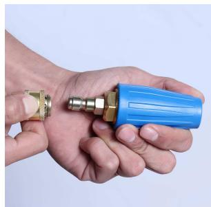
Boquilla Turbo 360° Danau 4000PSI, 610151050, provee un chorro concentrado rotativo en 360° que facilita la limpieza hasta 10 veces mas que una boquilla tradicional. Contiene un núcleo y asiento de cerámica de alta resistencia, un rotor duradero de metal y una carcasa interna en bronce ultra gruesa para garantizar una larga vida útil y un giro suave. La boquilla turbo es susceptible de obstrucción con suciedad y escombros por lo que se sugiere el uso del filtros de alta presión.
