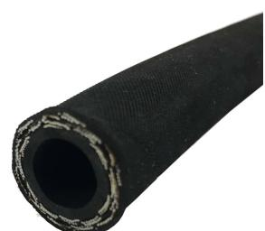
Manguera Hidrolavadora 4000psi x 10mt Danau 610043570, Doble alma trenzada en alambre de acero de alta resistencia, cubierta con tela de goma (Caucho). Presión de rotura 4: 1 de la presión de trabajo nominal. Sistema de acople y desconexión rápido QD de 3/8 ». lo que le permite de ser necesario, crear extensiones de manguera de mayor longitud con toda facilidad y seguridad.
