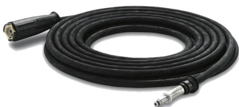
Manguera Karcher AVS 3600PSI 10mt, 6.391-238.0, con conexión AVS patentada en la pistola (alojamiento giratorio) y acoplamiento de rosca manual. M 22 x 1,5 con protección contra flexiones. AN 6 / 155 °C / 250 bar
