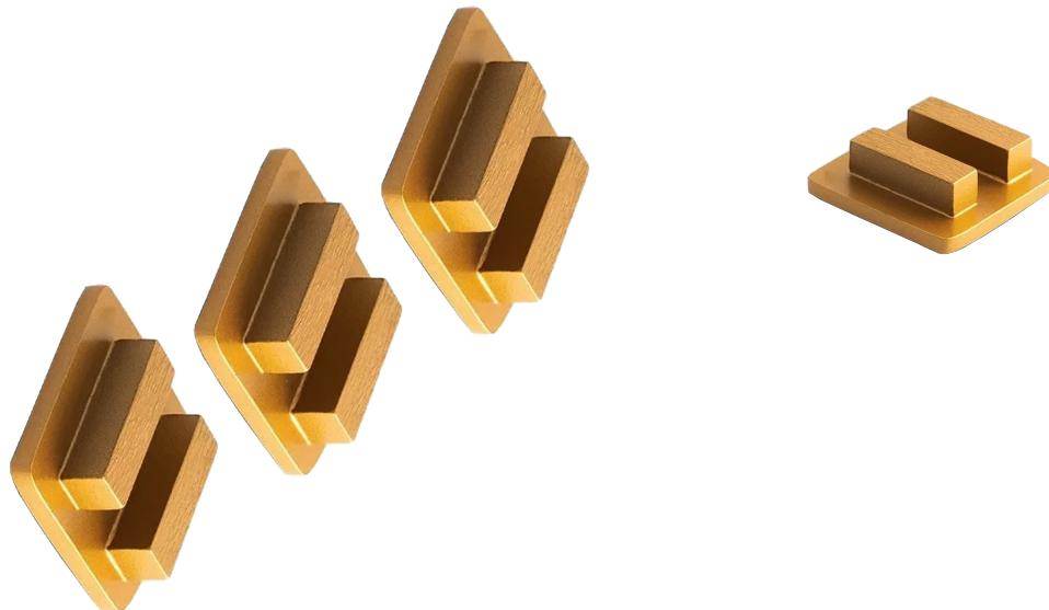
Segmento Diamante Desbaste Husqvarna G473D Doble Rectangular Grano 20/30 x3Und, 582850203, diamante suave para superficie dura, Redi Lock® es un sistema instantáneo y sin complicaciones para cambiar herramientas de diamante, óptimo para: Hormigón (blando), pegamentos cerámicos porosos, pegamentos cerámicos tipo plástico, aceptable en: hormigón medio, hormigón dañado por la lluvia, pegamentos vinílicos, pinturas y epoxis finos, epoxis espesos.
