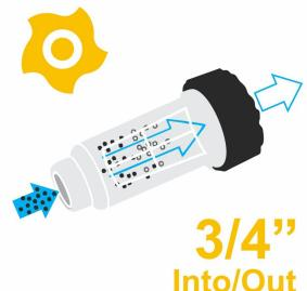
Filtro Hidrolavadora 80 micras, de entrada de agua en línea tipo taza, su pantalla impide el paso de objetos de tamaño de hasta 80 $\mu$  (micrones), su contenedor transparente facilita identificar impurezas atrapadas en la pantalla, Marco en plástico disponible para malla de 80, 150, 200.
