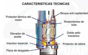
Electrobomba Tsurumi Aguas Negras 2" Des 4Hp 220/440V 3F 50NH23.0, línea profesional impulsor con cuchilla, plato de succión aserrado usado en combinación con un impulsor con un inserto (cuchilla) de tungsteno, aseguran que se puedan cortar las partículas sólidas presentes en las aguas residuales, bombeando las aguas negras y evitando atascamientos de la tubería.
