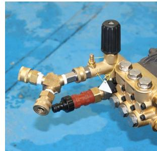
Regulador de presión Bomba Danau DBD-1807A/C Y DBC-15085A/C , 503040130K, controla la potencia e intensidad de chorro del agua, permitiendo un total control y aplicando la presión requerida de acuerdo a la exigencia de las diferentes aplicaciones, se debe tener especial cuidado con el manejo de las altas presiones de agua por lo que se recomienda un uso controlado, piezas No: 44, 45, 46, 47, 48, 49, 50, 51, 52, 53
