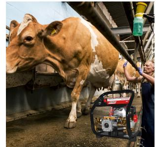
Motobomba Lava ganado KTC 4T Gasolina 1.4Hp Max 31cc 499-P768-4S Bomba 100% aleación de bronce para mayor durabilidad y resistencia a la oxidación, mangueras de fumigación fabricada con materiales de alta calidad para garantizar una mayor durabilidad y resistencia al daño/desgaste, ideal para • Fumigación de cultivos. • Lavado de ganado. • Aspersión de plantaciones agrícolas. • Entre otras.
