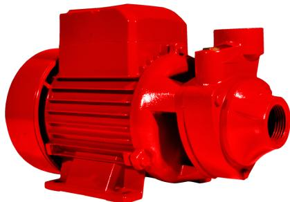
Electrobomba Periférica KTC Hierro 1 x 1 1.0Hp 110/220V 1F 448-EPP10, está fabricada en hierro fundido y equipada con bobinado 100 % cobre, eje en acero inoxidable y protección térmica. Ofrece un caudal máximo de 50 L/min y una elevación de hasta 65 mca, ideal para suministro doméstico, riego, sistemas contra incendios y aplicaciones industriales. Compacta y confiable (33 x 19 x 21 cm, 8.5 kg), garantiza eficiencia y durabilidad con 1 año de garantía.
